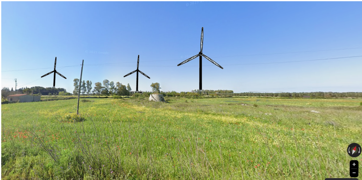
Fig. 3 – Esempio di impatto visuale degli aerogeneratori sullo skyline visibile dal lato nord SP 48
